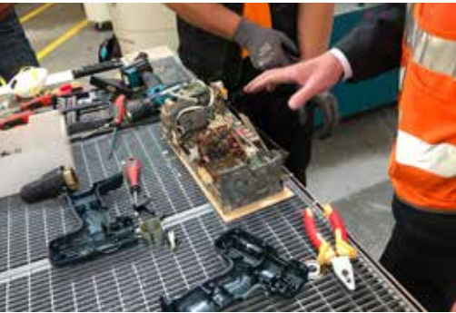
Die manuelle Vorzerlegung bringt Vorteile für die Rückgewinnung von Rohstoffen.
